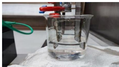
Figura 1. Celda electroquímica con muestra contaminada con hierro.
