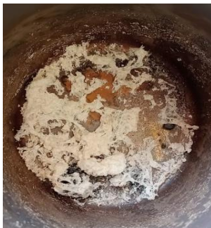
Figura 5. Cenizas obtenidas después de haber tratado la muestra en la mufla a 600°C
