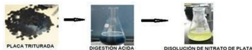
Figura 1. Proceso de la digestión química para la obtención de plata a partir de placas radiográficas
