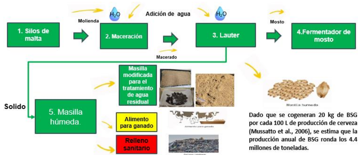
Figura 2. Proceso de producción de masilla. En la elaboración de cerveza tradicional que usa un lauter, la masilla juega un papel importante ya que forma el lecho a través del cual se filtra el mosto [9].
