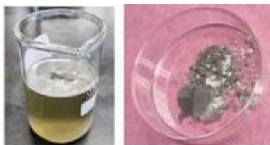
Figura 3. Formación de la plata con el extracto de Eucalipto en etanol
