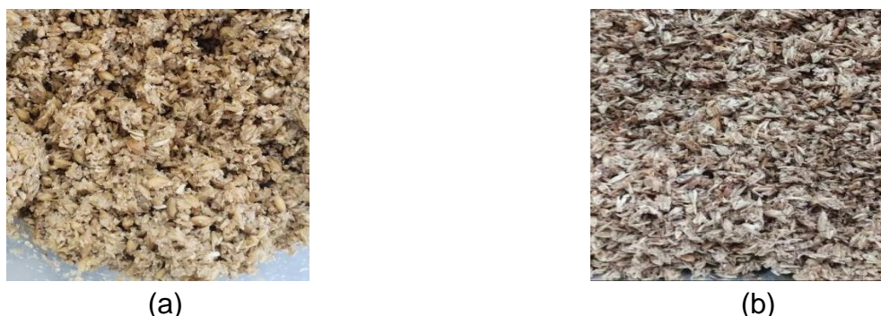
Figura 1. Materia Prima. a) Bagazo cervecero, donde se puede observar que los granos se encuentran aglomerados debido a él gran porcentaje de humedad que presenta. (b) Textura del grano seco, donde se puede visualizar una mejor distribución del grano.
