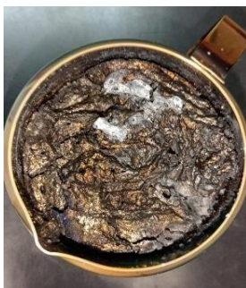
Figura 4. Miel carbonizada después de haber sido sometida al pretratamiento con soplete.
