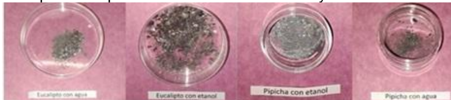
Figura 4. Plata recuperada con los extractos acuosos y alcohólicos de Eucalipto y Pipicha.
