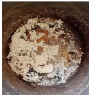
Figura 5. Cenizas obtenidas después de haber tratado la muestra en la mufla a 600°C
