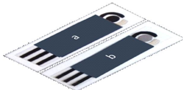
Figura 2. Muestra la superficie real de electrodo de carbono a) sin modificar, b) modificado con Se.
