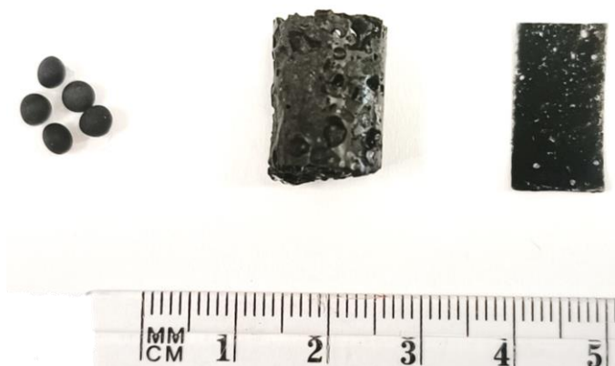
Figura 1. Fases adsorbentes fabricadas a partir de carbón activado y PS.
