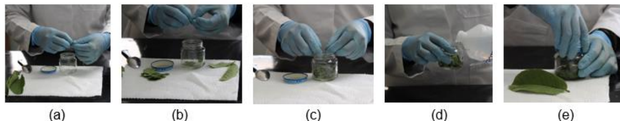
Figura 2. Extracción de la muestra de pigmentos a separar (hojas de guayabo) a) Troceado de las hojas de guayabo, b) y c) introducción de trozos pequeños de la muestra a separar un recipiente, d) Adición de eluyente hasta cubrir por completo la muestra, e) Protección de la muestra (reposo) para favorecer la extracción de la muestra.
